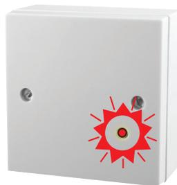
Drücken des Hauscodierungstasters auf der Rückseite, bis die Kontrollleuchte auf der Frontseite rot aufleuchtet. Taster loslassen. Die rote LED blinkt kurz auf, wenn das Gerät in den Hauscodierungsmodus schaltet.
