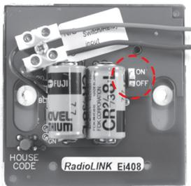
Einschalten des Eingangsmoduls durch Schieben des Schalters auf der Rückseite in „ON“-Stellung.
